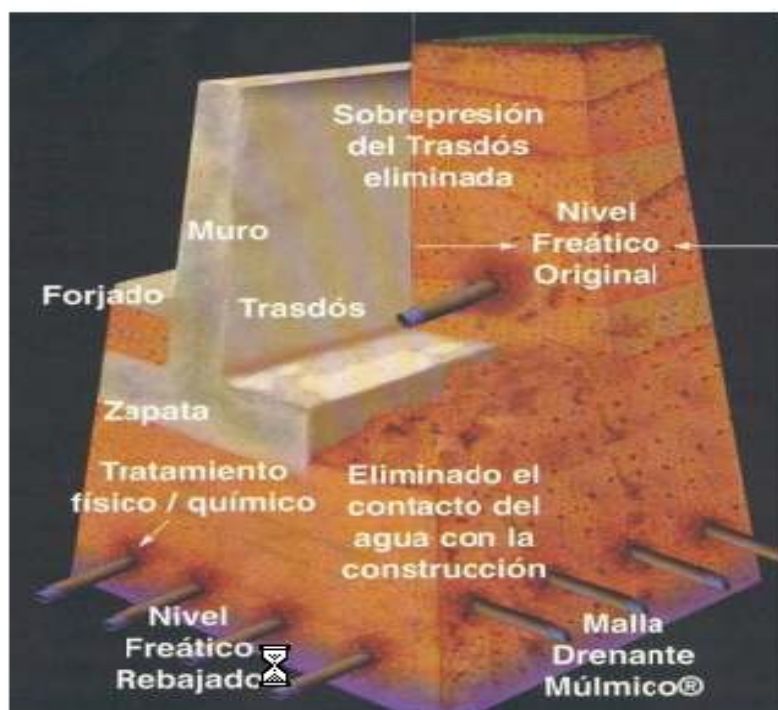
Fig. 9. Representación gráfica del sistema Mulmico.
